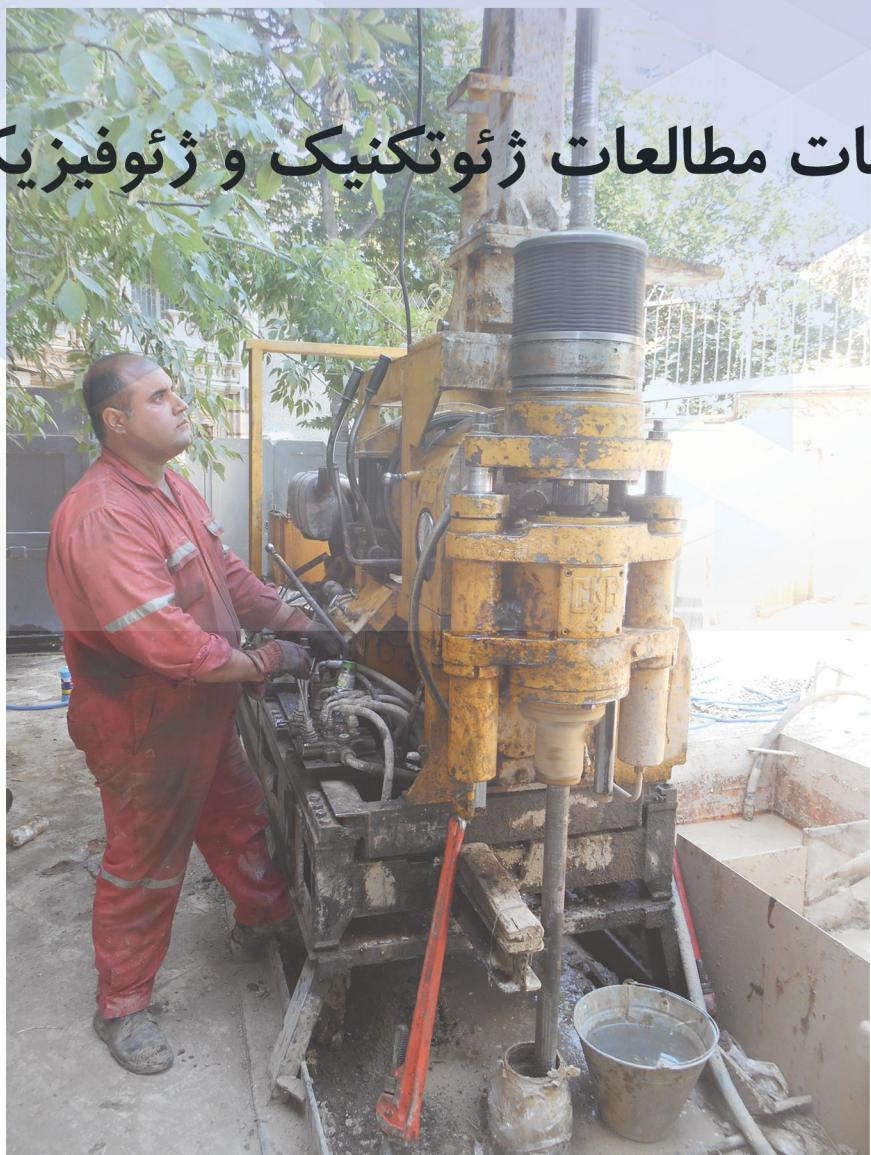
انجام عملیات حفاری به منظور شناسایی لایه های تحت اراضی و اخذ نمونه های دست خورده و دست نخورده به منظور تعیین پارامترهای مقاومتی خاک
